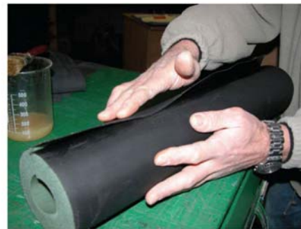
... и приступайте к финальному закрытию шва, аккуратно прижимая нахлест к ответной части покрытия.
